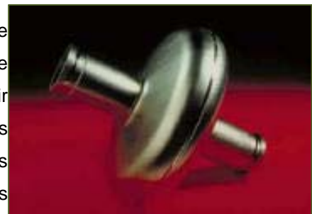
Cavité accélératrice supraconductrice en niobium. ©CEA/Irfu
