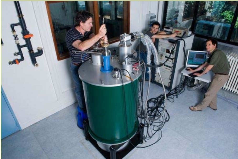
Le cylindre vert est une bobine pour produire un champ magnétique très élevé pour des mesures de résonance magnétique nucléaire (RMN). ©RAJAU Benoît (cette photo est disponible auprès de la photothèque du CNRS)
